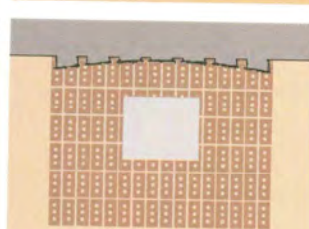
台は穴開きレンガ、壁は金属板を組み合わせる。
