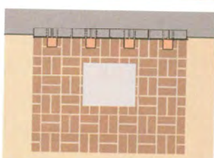
台はレンガの市松貼り、壁は1/4ずらして積み部分的に飛び出させる。
