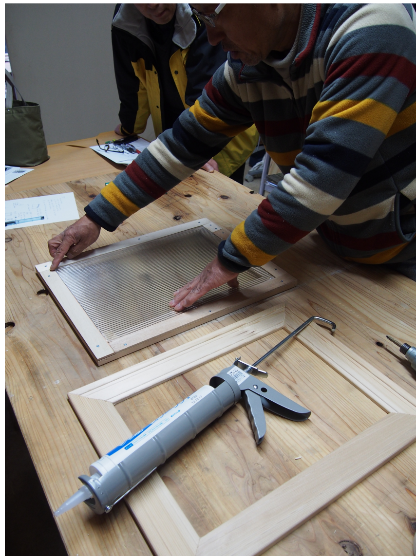
ガラスとほぼ同じ厚みのベニヤに木工用ボンドを塗ってガラスの周り、額縁の外面に合せて置く。ベニヤと額縁をビスで固定する
