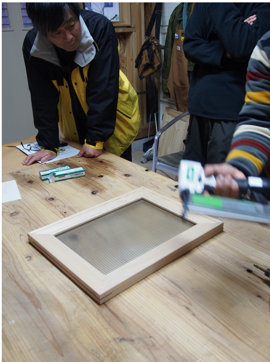
フィニッシュネイル釘打機に25mmフィニッシュネイルを装着して 4隅を釘打ちすれば完成
